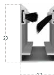
Section coulisse inférieure
